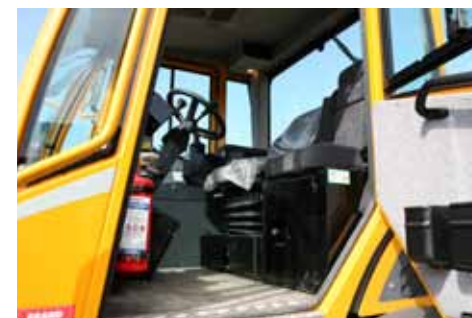
Ett avsteg från standardutförandet är att det finns plats även för en passagerare, men därmed har den roterande förarstolen fått ersättas av en fast.
