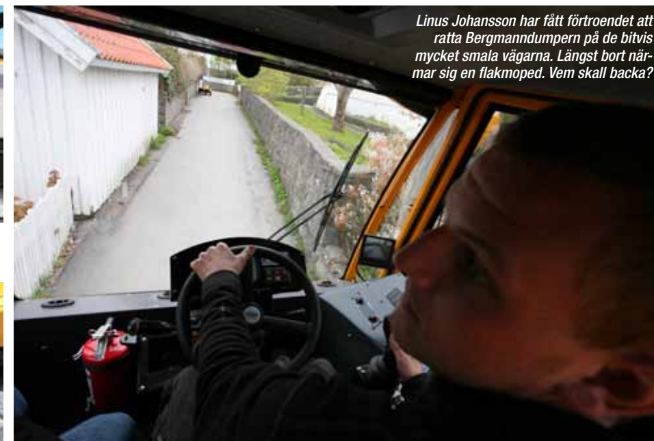
Ett avsteg från standardutförandet är att det finns plats även för en passagerare, men därmed har den roterande förarstolen fått ersättas av en fast.
